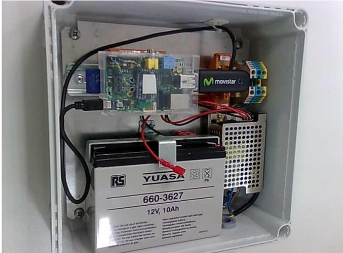
Las dimensiones son de 28x28x13 centímetros y el peso aproximado de es 6 kilogramos (con batería), por lo que requiere un anclaje robusto y seguro.
